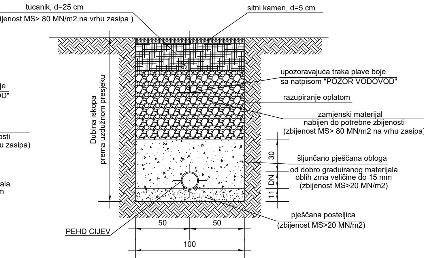
**POPREČNI PRESJEK ROVA
