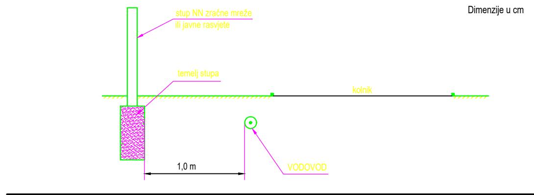
Križanje energetskih kabela i vodovoda - kabel iznad vodovoda
