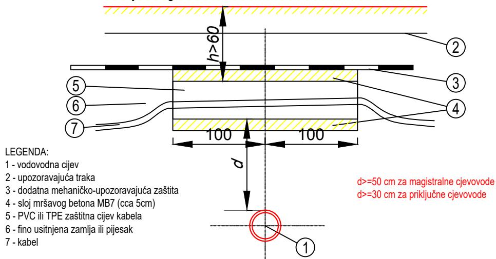
Paralelno vođenje i približavanje energetskih kabela i vodovoda
