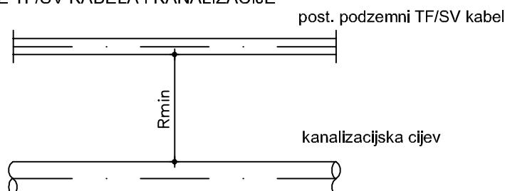
$R_{min} \geq 50$  cm za kanalizacijske cjevovode promjera do 60 cm $R_{min} \geq 150$  cm za kanalizacijske cjevovode promjera 60 cm i većegako je  $R < 200$  cm ISKOP IZVESTI RUČNO UZ POVEĆAN OPREZ
