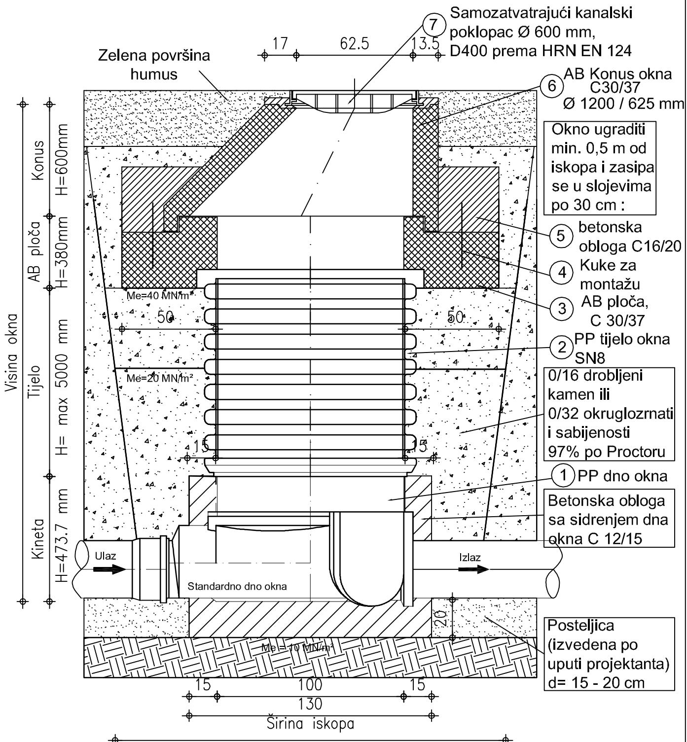
Bratljenjem spojeva AB konusa, AB ploče i PP revizijskog okna potrebno je osigurati potpunu vodonepropusnost kanalizacijskog sustava!
