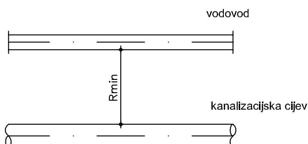
$R_{min} \geq 50 \text{ cm}$  za kanalizacijski cjevovod
