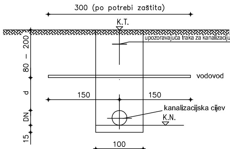
$d_{min} \geq 30 \text{ cm}$  za kanalizacijski cjevovod
