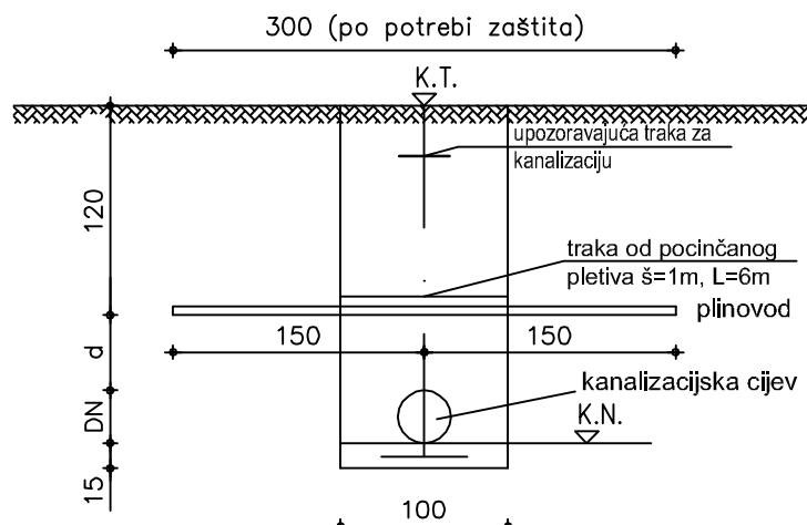
$d_{min} \geq 50 \text{ cm}$  za kanalizacijski cjevovod
