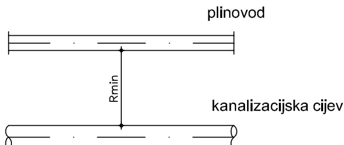
$R_{min} \geq 100 \text{ cm}$  za kanalizacijski cjevovod
